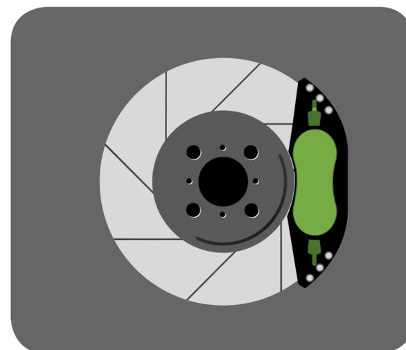
Se recomienda realizar una **revisión completa del sistema de frenos una vez al año o cada 20.000 km**. En esa revisión se debe verificar el estado de la bomba de freno y los bombines de rueda (que no presenten síntomas de agarrotamiento ni fugas de líquido), el desgaste de las pastillas de freno, los tambores y los discos, la presión del sistema y el servofreno.
