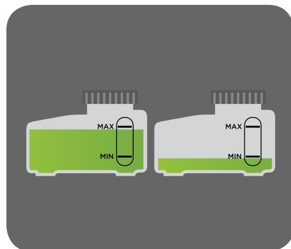
El **nivel del líquido de frenos** debe mantenerse dentro de los límites establecidos y por ello se debe revisar de forma periódica y/o sustituirlo según las recomendaciones del fabricante. Si se encontrara bajo, además de agregar líquido hay que verificar posibles fugas.
