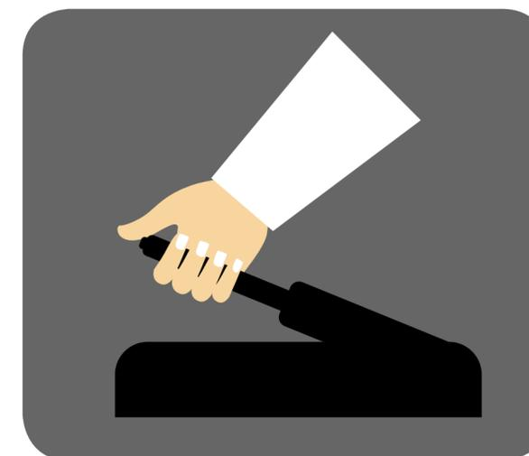
Es recomendable que se compruebe la eficacia del freno de estacionamiento (**freno de mano**). Las pastillas de freno tienen una duración media de 40.000 a 50.000 km. Aunque el freno no se utilice demasiado, las pastillas no deben estar en uso durante más de 90.000 km, ya que se cristalizan y pierden capacidad de frenado.
